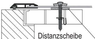
Um eine Weißverfärbung des Gewebes zu reduzieren muss die Distanzscheibe zwischen V2A-Gewebe und verzinktem Gitterrost montiert werden.
