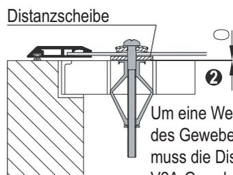
Um eine Weißverfärbung des Gewebes zu vermeiden muss die Distanzscheibe zwischen V2A-Gewebe und verzinktem Gitterrost montiert werden.
