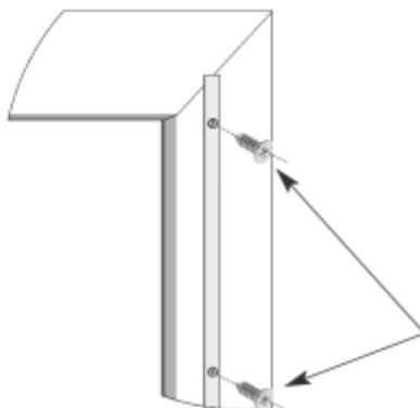
Drehrahmen öffnen und Edelstahlgegenband mit Schrauben SK 2,9x9,6 anschrauben.
