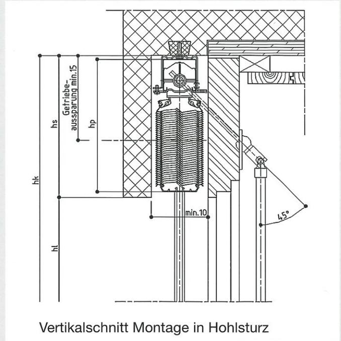
Vertikalschnitt Montage in Hohlsturz
