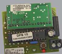
Funk-Empfänger Für Fernbedienung (auch lieferbar mit Gehäuse)
