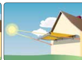
Tiefstehende Sonne z.B. Westfassade
